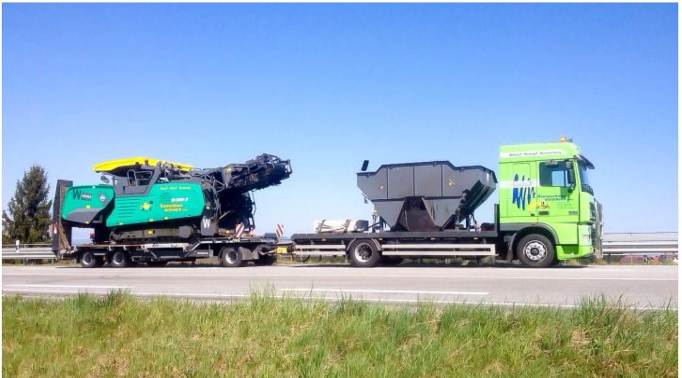
Der MT 300-2 ermöglicht eine ununterbrochene, berührungsfreie Mischgutzufuhr zum Fertiger, um den Materialeinbau an keiner Stelle unterbrechen zu müssen.
